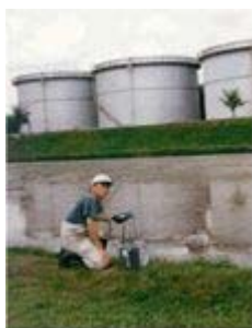
マレーシア・FELDA 社 Seriting Hilir 工場の廃液処理池から放出されるメタンガス量の測定
