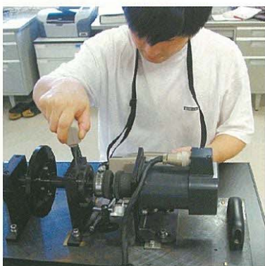
大学院生によるミスアライメントの異常検出実験の様子
