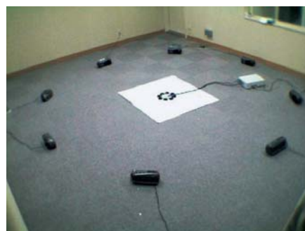
図2 8音声の分離実験(真中に8個のマイクロホン、周囲に8個のスピーカがある)
