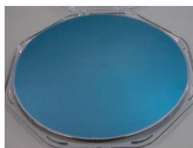
写真2：200mm(8インチ)口径絶縁層埋め込み型SiCウェーハ
