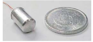
図1 消化管内走行カプセル外観
